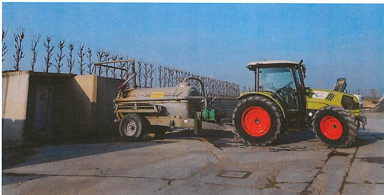
Figura 2 – Autobotte impiegata nell'umidificazione delle superfici
